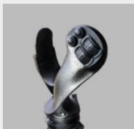
Manipolatori avanzati, fino a 13 funzioni secondo il modello di macchina.
