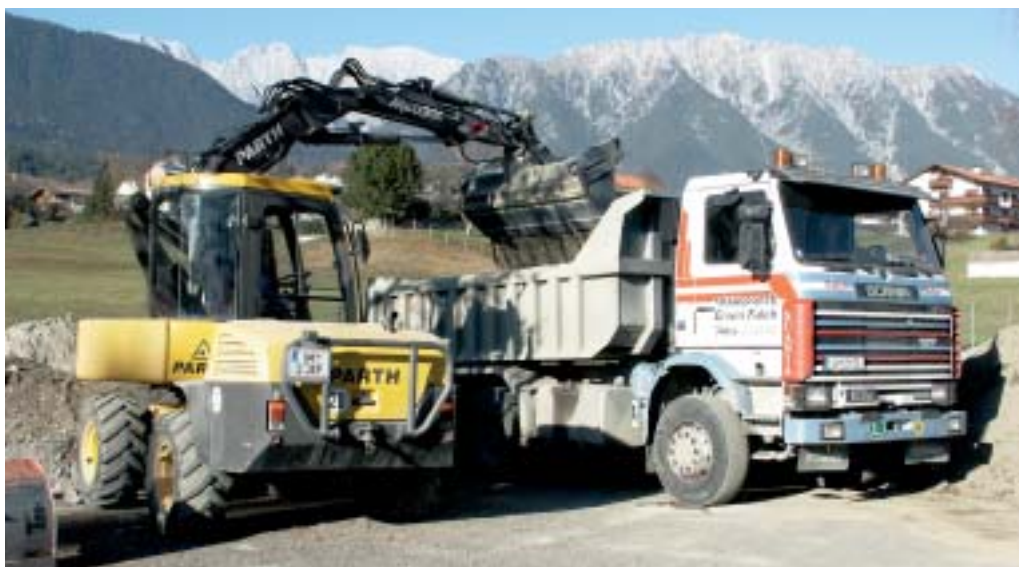
▲ Caricamento di ghiaia con la benna 4x1.
