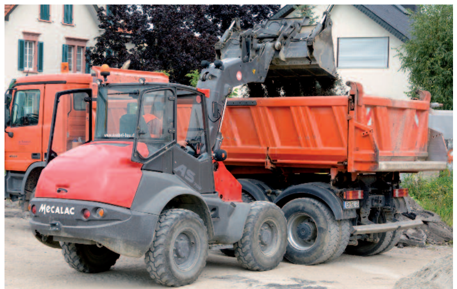
▲ Die Booster-Kinematik erleichtert das Verladen von Schotter auf den Lkw.
