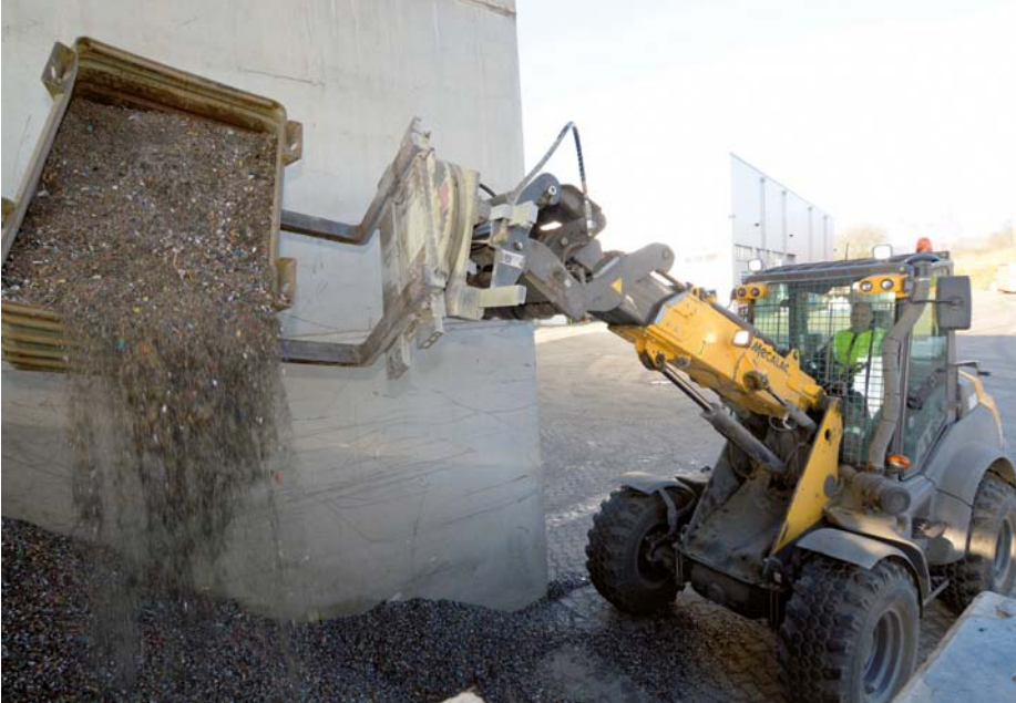
➔ Ausgestattet mit einem Kistendrehgerät werden mit dem AT 900 schwere, mit Rohstoffen gefüllte Kisten umgeschlagen.
