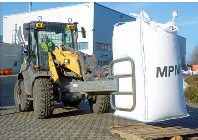
➔ Die recycelten Rohstoffe werden anschließend in Big-Bags verpackt und auf Lkw geladen.
